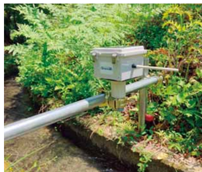
水路に設置した水位センサー(吉延)
