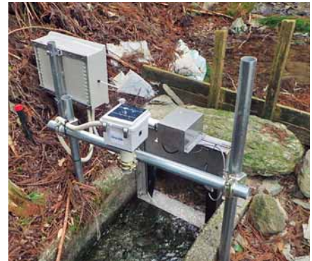
水路に設置した水門ゲートと水位センサー (上)(下) (吉延)
