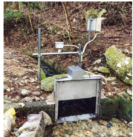
水路に設置した水門ゲートと水位センサー (上)(下) (吉延)
